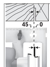
Le marquage de coupe 0° (9) indique la position de la lame de scie lors d'une coupe à angle droit. Le marquage de coupe 45° (8) indique la position de la lame de scie lors d'une coupe à angle de 45°.
