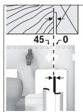
Tanda pemotongan  $0^\circ$  (9) menunjukkan posisi mata gergaji pada pemotongan persegi. Tanda pemotongan  $45^\circ$  (8) menunjukkan posisi pada mata gergaji pemotongan  $45^\circ$ .
