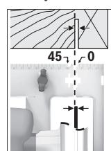
A marcação de corte 0° (9) indica a posição do disco de serra num corte em ângulo reto. A marcação de corte 45° (8) indica a posição do disco de serra num corte num ângulo de 45°.
