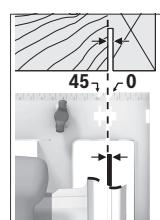
เครื่องหมายตัด  $0^\circ$  (9) แสดงตำแหน่งของใบเลือยสำหรับการตัดเบื้องมุมจากเครื่องหมายตัด  $45^\circ$  (8) แสดงตำแหน่งของใบเลือยสำหรับการตัด  $45^\circ$
