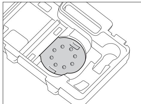
为方便校准磨垫(5)上的砂纸(6)，可使用工具箱中如图所示的校准辅助工具。将砂纸和魔术贴向上装入校准辅助工具，并用磨垫牢牢压紧电动工具。
