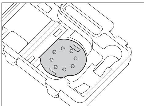
若要輕鬆在磨盤上（5）對準研磨片（6）的位置，您可使用工具箱裡的校正輔助工具（如圖中所示）。研磨片的魔鬼氈那一面朝上，將它放進校正輔助工具中，接著再將電動工具上的磨盤用力按壓上去。
