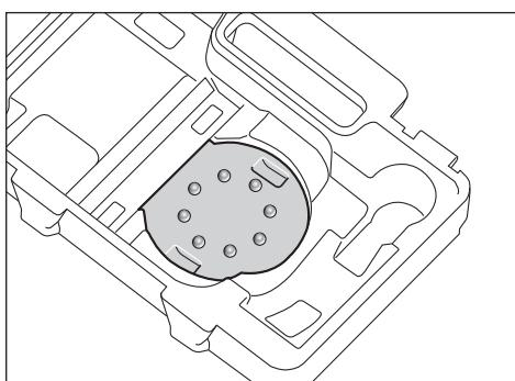
Để điều chỉnh đơn giản giấy nhám (6) ở đĩa chà (5) bạn có thể sử dụng sự trợ giúp hiệu chỉnh được hiển thị trong ảnh ở trong hộp dụng cụ. Hãy đặt giấy nhám có sợi băng dán xe lên trên vào dụng cụ
