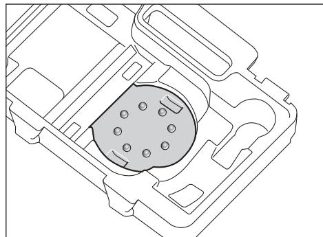
Untuk pengaturan kertas ampelas yang mudah (6) pada piringan (5), Anda dapat menggunakan bantuan pengaturan yang ditunjukkan pada gambar di dalam tas perkakas. Letakkan kertas ampelas dengan perekat ke arah atas ke dalam bantuan pengaturan dan tekan perkakas listrik dengan piringan.
