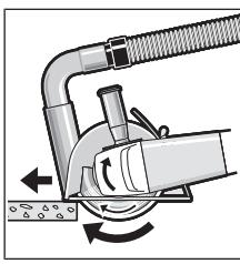
接通电动工具，并把引导向滑座的前部放在工件上。参考工作的物料，适当地施力推进机器。切割高硬度的工件时，例如碎石含量很高的水泥，可能因为金刚石切割片过热而导致切割片损坏。金刚石切割片的周围会出现明显的火花。
