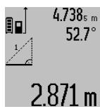
当您完成测量步骤后，仪器会将 "X" 线段的值显示在测量结果显示列 c 上。"1" 线段的测量值和角度 "α" 会出现在测量值显示列 a。
