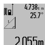
Setelah pengukuran rampung, hasil dari jarak yang diukur „**X**“ tampil pada garis hasil pengukuran **c**. Nilai-nilai pengukuran dari jarak „**1**“ dan sudut „**a**“ tampil pada garis-garis nilai pengukuran **a**.
