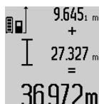
按下结果显示按键 6 后仪器便会显示两个测量值的总和。计算过程会出现在测量值显示列 a，总和则显示在测量结果显示列 c。
