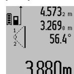
Setelah pengukuran rampung, hasil dari jarak yang diukur „**X**“ tampil pada garis hasil pengukuran **c**. Nilai-nilai pengukuran untuk jarak-jarak „**1**“, „**2**“ dan sudut „**a**“ tampil pada garis-garis nilai pengukuran **a**.
