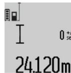
到了設定的時間儀器便會自動測量。使用其他的測量功能測量距離時也可以使用計時功能（例如面積測量）。但是該功能無法用在累加測量結果，減除測量結果以及持續測量時。
