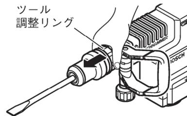
2. ツール調整リング④を回して、先端工具を任意の向きにセットします。
