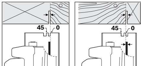
0 度角的鋸割記號 (8)，標示了直角鋸割時的鋸片位置。45 度角的鋸割記號 (7)，標示了 45 度角斜鋸時的鋸片位置。
