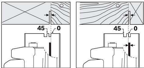
절단 표시 0° (8) 는 직각 절단을 할 때 톱날의 위치를 나타냅니다. 절단 표시 45° (7) 는 45° 각도로 절단할 때 톱날의 위치를 나타냅니다.
