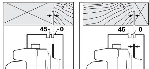
Tanda pemotongan **0°** (8) menunjukkan posisi mata gergaji pada pemotongan dengan sudut siku. Tanda pemotongan **45°** (7) menunjukkan posisi mata gergaji pada pemotongan dengan sudut **45°**.
