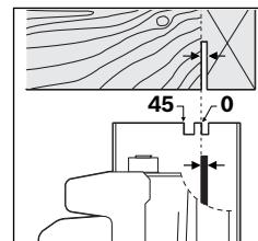
เครื่องหมายตัด 0° (8) แสดงตำแหน่งของใบเลื่อยสำหรับการตัดเป็นมุมจาก เครื่องหมายตัด 45° (7) แสดงตำแหน่งของใบเลื่อยสำหรับการตัด 45°
