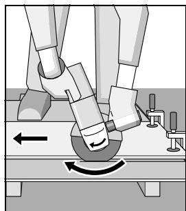
必須逆著機器的轉向推動電動工具，否則容易失控，並導致電動工具從切線中滑出。
