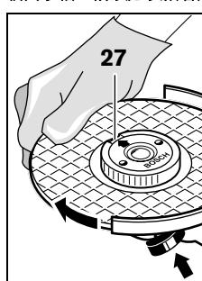
使用主軸鎖定鍵 1 固定主軸。然後朝著順時針的方向用力地轉動砂輪，以便擰緊快速螺母。
