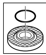
ขันพลาสติก (โอ-ริง) จะติดตั้งอยู่รอบบ่า ตรงกลางของน็อตของงาน 7 หาก โอ-ริงหายหรือชำรุด ต้องเปลี่ยนน็อตของงาน 7 ใหม่ก่อนเริ่มใช้งานเครื่องต่อไป
