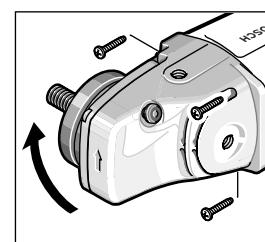
机器操作者可根据需要分段式转动机头，每一段的旋转角度为 90 度。此功能的优点是能够在特殊的工作状况下，把起停开关移动到比较容易操作的位置。例如切割时使用能够配合导引板的吸尘罩 24，或者针对左撇子。
