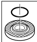
Chi tiết bằng nhựa (vòng đệm chữ O) được lắp vào vành định tâm của bích lắp 7. **Nếu vòng đệm chữ O bị mất hay bị hư,** phải thay bích lắp 7 trước khi cho máy hoạt động trở lại.
