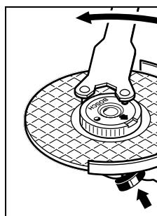
如果安裝正確，而且快速螺母未損壞的話，一般可以用手朝著逆時針方向轉松快速螺母。
