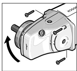
Đầu máy có thể xoay được đối với vỏ máy ở vào 90° nấc. Bằng cách này, công tắc Tắt/Mở có thể mang lại vị trí thuận lợi hơn đối với các tình huống gia công đặc biệt, vd., gia công cắt có sử dụng đường cắt có
