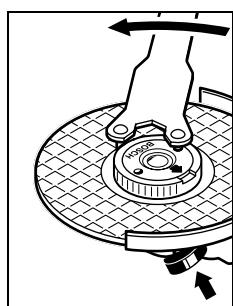
如果安装正确，而且快速螺母未损坏的话，一般可以用手朝著逆时针方向转松快速螺母。
