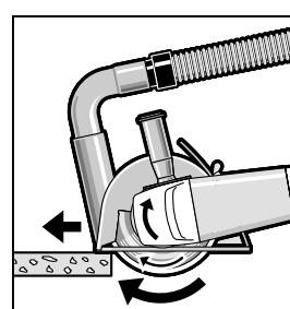
开动电动工具，并把导引装置的前端放置在工件上。参考工件的物料，适当地施力推进机器。
