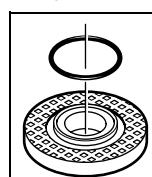
Di dalam flens untuk poros kerja 7 di sekitar tingkatan pemasangan ada satu bagian dari bahan sintetik (ring-O). Jika ring-O tidak ada atau rusak, flens untuk poros kerja 7 mutlak harus digantikan, sebelum Anda melanjutkan penggunaan perkakas.
