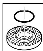
在固定法兰 7 的定心轴环上有一个塑料零件（O 形环）。如果缺少 O 形环或 O 形环损坏了，务必在继续使用之前更换固定法兰 7。
