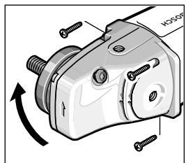
cocok, misalnya untuk memotong dengan kap penghisap dengan mistar jarak **24** atau untuk orang kidal.
