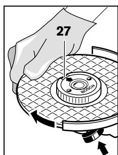
使用主轴锁定键 1 固定主轴。然后朝著顺时针的方向用力地转动砂轮，以便拧紧快速螺母。
