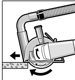
เบคเครื่องทำงาน และวางแผนหน้าของแผ่นนำ การตัดบนชิ้นงาน เคลื่อนเครื่องไปข้างหน้าด้วย ความเร็วของปั๊มน้ำที่เหมาะสมกับวัสดุชิ้นงานที่กำลังตัดอยู่
