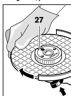
Tekan tombol penahan poros kerja 1 untuk menahan poros kerja. Untuk mengencangkan mur untuk poros kerja yang dibuka dan dikunci dengan tangan, putarkan mata gerinda dalam arah jalannya jarum jam dengan keras.
