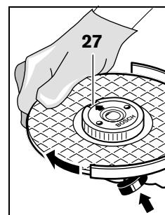
Khóa trực máy mài bằng nút khóa trực máy 1. Để siết chặt đai ốc khóa nhanh, xoay thật chặt dĩa mài theo chiều đồng hồ.
