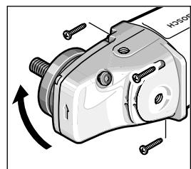
機器操作者可根據需要分段式轉動機頭，每一段的旋轉角度為 90 度。此功能的優點是能夠在特殊的工作狀況下，把起停開關移動到比較容易操作的位置。例如切割時使用能夠配合導引板的吸塵罩 24，或者針對左撇子。
