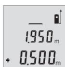
측정값을 더하려면 버튼 (6)을 누르거나, 측정값을 빼려면 버튼 (3)을 누르십시오. 디스플레이 하단에 "+" 또는 "-"가 표시됩니다. 다시 측정을 진행하십시오. 현재 측정값은 디스플레이 하단에, 이전 측정값은 그 위에 표시됩니다.
