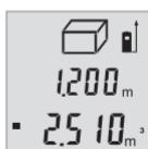
当您完成第三个测量步骤后，仪器会自动进行运算并显示运算所得的体积。最终结果显示在显示屏下端，当前测量值则显示在其上方。
