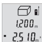
세 번째 측정을 하고나면 체적이 자동으로 계산되어 나타납니다. 최종 결과가 디스플레이 하단에, 현재 측정값이 그 위에 표시됩니다.
