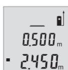
如需相加测量值，按压按键(6)，如需相减测量值，按压按键(3)。结果显示在显示屏下端的“=”之后，当前测量值则显示在其上方。
