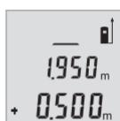
如需相加测量值，按压按键(6)，如需相减测量值，按压按键(3)。显示屏下端出现“+”或“-”。请进行另一项测量。当前测量值显示在显示屏下端，之前的测量值则显示在其上方。
