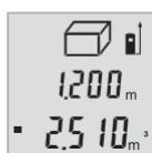
完成第三次測量後，測量工具將自動計算出體積並於畫面中顯示該值。最後的計算結果位於顯示器下方，而實際測量值則位於其上方。
