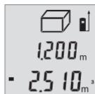
Setelah pengukuran ketiga selesai, volume secara otomatis dihitung dan ditampilkan. Hasil akhir pengukuran terletak pada display bagian bawah, nilai pengukuran saat ini terletak di atasnya.
