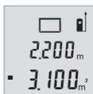
两次测量结束后会自动计算和显示面积。最终结果显示在显示屏下端，当前测量值则显示在其上方。
