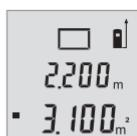
두 번째 측정을 하고나면 면적이 자동으로 계산되어 나타납니다. 최종 결과가 디스플레이 하단에, 현재 측정값이 그 위에 표시됩니다.
