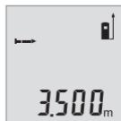
Gerakkan alat pengukur beberapa saat hingga jarak yang diinginkan muncul pada display (1) di bagian bawah.
