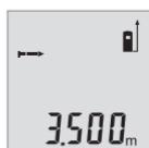
移動測量工具，直到所需距離出現在顯示器 (1) 下方為止。再按一下測量按鈕 (2) 即可結束連續測量功能。上一次的測量結果會出現在顯示器下方。
