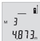
测量值编号显示在“M”后面，相应的测量值则显示在其下方。
