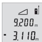
完成第二次測量後，將自動計算出高度並於畫面中顯示該值。最後的計算結果位於顯示器下方，而實際測量值則位於其上方。
