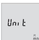
Tekan lama tombol on/off **(5)**. Jika satuan ukur yang diinginkan ditampilkan, lepaskan tombol on/off **(5)**. Setelah itu, alat pengukur akan hidup dengan pengaturan yang dipilih.
