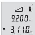
第二次测量结束后会自动计算和显示高度。最终结果显示在显示屏下端，当前测量值则显示在其上方。
