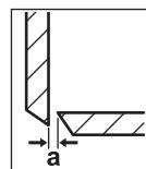
刀片距离a（刀刃之间的空隙）取决于待加工的金属板厚度 $d_{max}$ 。
