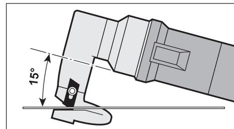
전동공구를 철판 표면에 15° 각도로 기울여 잡고, 축면으로 잘못 기울이는 일이 없도록 하십시오. 전동공구를 일정하게 가볍게 누르면서 절단 방향으로 움직입니다. 무리하게 밀면서 작업하면 날의 수명이 훨씬 짧아지며 전동공구를 손상시킬 수 있습니다.
