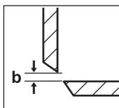
สำหรับการปรับความห่างในมีด b ตัวอย่าง (7) ของใบมีดบนที่ศูนย์ด้วยบาน เปิดสวิตซ์เครื่องมือไฟฟ้า เป็นระยะเวลาช้าๆ ครู่ๆ และปิดสวิตซ์ อาจจำเป็นต้องดำเนินขั้นตอนข้างต่อไป
