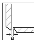
刀片間距 a (刀刃之間的空隙) 取決於欲加工之金屬板厚度  $d_{max}$ 。
