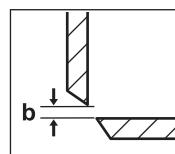
调节刀片距离b时上刀片冲杆(7)必须位于上死点。为此将电动工具短暂开机，然后重新关闭。必要时重复该过程。
