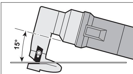
握持本電動工具時，它應前傾與金屬板表面呈 15° 傾角，而不應該側向傾斜。
