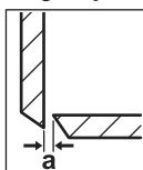
Jarak pisau **a** (jarak antar pemotongan) bergantung pada ketebalan pelat logam  $d_{\max}$  yang akan dikerjakan.
