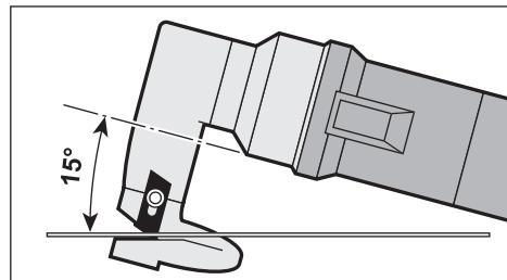
Pegang perkakas listrik pada sudut 15° ke permukaan pelat dan jangan miringkan ke samping.
