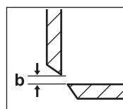
若要調整刀片間距 b，上刀片的沖桿 (7) 必須位於上止點。此外請快速啟動電動工具，然後再次關閉。必要時須重複此程序。
