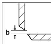
Để điều chỉnh khoảng hở lưỡi cắt **b** tấm chấn (7) của lưỡi cắt trên phải ở trên điểm chấn bên trên. Do đó, hãy bật nhanh dụng cụ điện và lai tắt. Nếu cần, hãy lắp lại quá trình.
