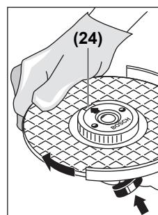
按压主轴锁定键(1)来固定研磨主轴。固定快速夹紧螺母时，请顺时针用力旋转砂轮片。
