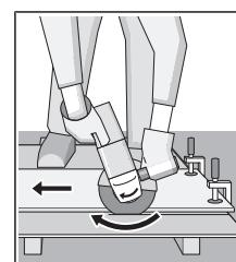
Máy luôn luôn phải được vận hành theo chuyển động mài ở tư thế thẳng đứng. Nếu không như vậy, có nguy cơ bị đẩy mài không điều khiển được máy ra khỏi mạch cắt. Khi cắt một thanh vật liệu có mặt nghiêng và góc vuông, tốt nhất là bắt đầu tại điểm có thiết diện nhỏ nhất.
