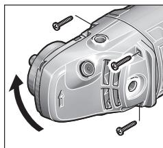
La tête de meuleuse est réglable par pas de 90°. Le fait de tourner le carter permet, lors de certaines applications, de placer l'interrupteur Marche/Arrêt dans une position plus pratique, par ex. lors de travaux de tronçonnage avec le capot de protection à glissière de guidage (21) ou pour les gauchers.
