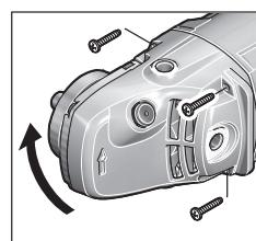
ท่านสามารถหมุนหัวเครื่อง เมื่นขันได้ดั้นละ 90° ในลักษณะนี้วิธีที่เปิด-ปิดสามารถเลื่อนไปอยู่ในตำแหน่งที่สะดวกของการใช้งานมากขึ้นเมื่อทำงานในสถานที่พิเศษ ด. ย. เช่น สำหรับงานตัดที่ใช้ภาครอบ
