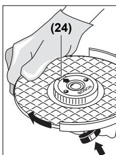
按壓主軸鎖止按鈕 (1)，即可鎖定磨削主軸。順時針用力轉動研磨砂輪即可將快速螺母旋緊。
