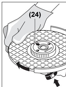
Khóa trực máy mài bằng nút khóa trực máy (1). Để siết chặt đai ốc khóa nhanh, xoay thật chặt đĩa mài theo chiều đồng hồ.
