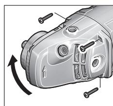
您可依照需求分段式轉動機頭，每一段的旋轉角度為 90 度。此功能的優點是能夠在特殊的工作狀況下，把起停開關移動到比較容易操作的位置，例如切割時使用具有引導板設計的吸塵罩 (21)，或是供左撇子使用。
