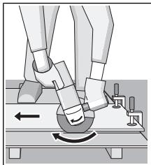
ต้องเคลื่อนเครื่องมือไฟฟ้าแบบตัดซึ้นเสื่อม มีฉะนั้นจะเกิดอันตรายจากการที่เครื่องถูกผลักออกจากร่องตัดอย่างความสูงไม่ได้ เมื่อต้องการตัดเส้นร้อนบนอกและก่อสีเหลี่ยม ขอแนะนำให้เริ่มตั้งแต่ดูที่มี刃ทั้ตดที่เล็กที่สุด
