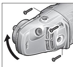
Kepala mesin dapat diputar  $90^\circ$  dalam setiap interval. Dengan demikian posisi tombol on/off dapat disesuaikan untuk berbagai pekerjaan khusus, misalnya untuk pekerjaan memotong dengan kap pengisap dengan unit pemandu (21) atau untuk orang kidal.
