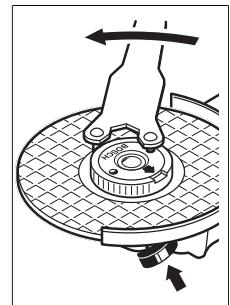
제대로 고정된 순상되지 않은 순간 교환 너트는 너트의 측면에 나있는 홈 부분을 잡고 시계 반대 방향으로 돌려서 손으로 풀 수가 있습니다. 꽉 끼워진 순간 교환 너트는 절대로 플라이 어를 사용하지 말고 투핀 스패너를 사용하여 풀어야 합니다. 투핀 스패너는 도면에 나온 대로 사용하십시오.
