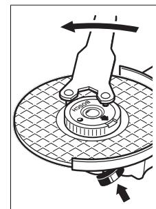
如果安装正确而且快速夹紧螺母未损坏，就可以上手逆时针方向松开滚花圆环。对于卡住的快速夹紧螺母，不要用钳子而是要用双销扳手松开。请参考插图安装双销扳手。
