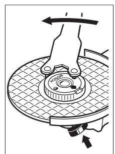
快速螺母如果安裝正確且無任何受損，您可徒手從滾花位置逆時針旋轉，以便鬆開快速螺母。如果無法用手取出快速螺母，則要使用雙銷扳手轉鬆螺母，千萬不可以使用鉗子強行轉開螺母。請如圖所示架上雙銷扳手。
